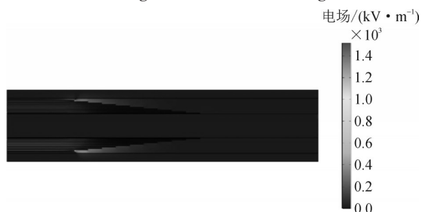
图 11 交直流电压下阀侧套管电场分布图
