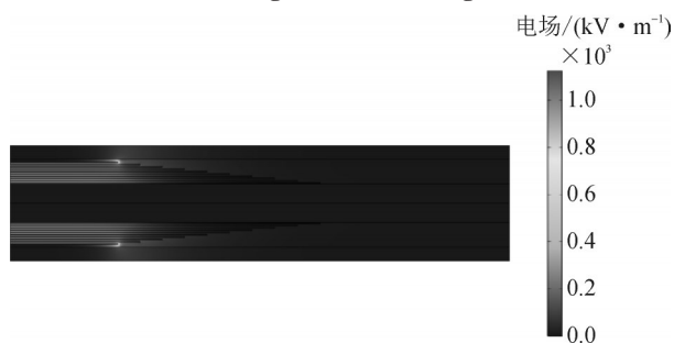
图8 交流电压下阀侧套管电场分布图
