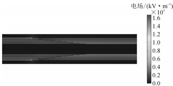
图5 直流电压下阀侧套管电场分布图
